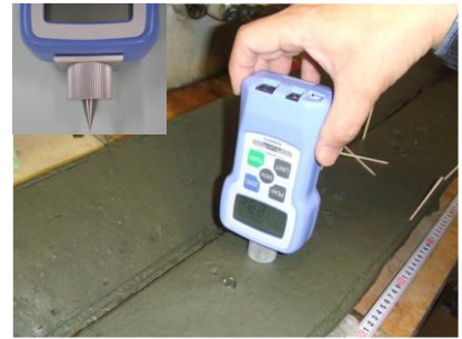
写真-2 コーン貫入試験
