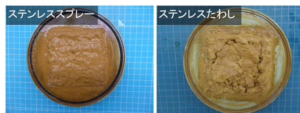
写真8 垂直透水試験後の試験片の様子
