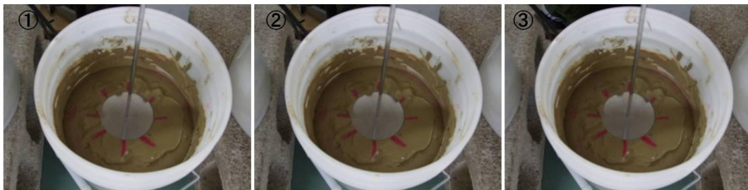
図-7 円筒を回転させた時の試料の動き
