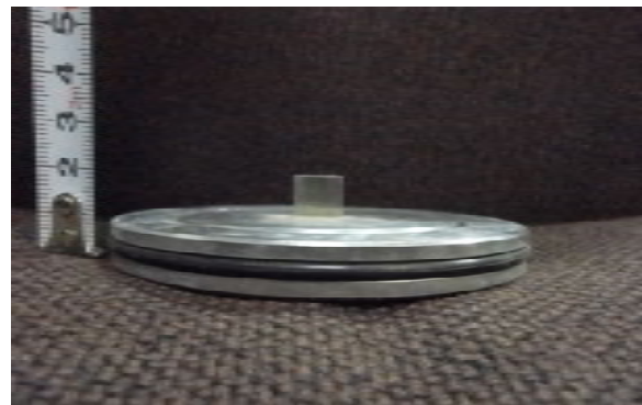
写真-1 ベンダーエレメント設置用金属板
