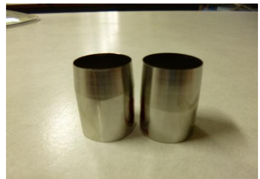
写真3 密度測定に用いたステンレス容器
