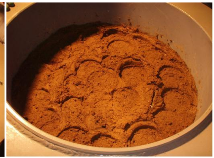
写真-3 突き固め後状況
