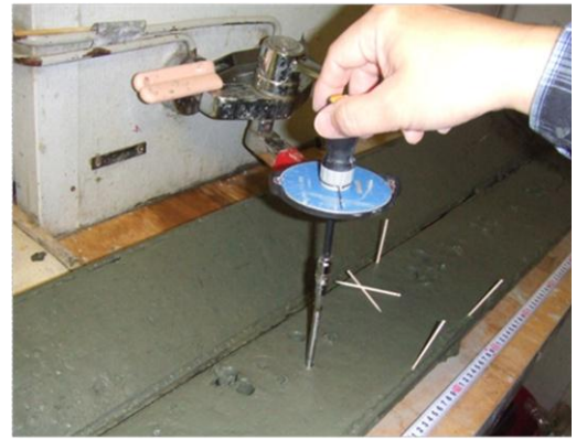
写真1 ベーンせん断試験
