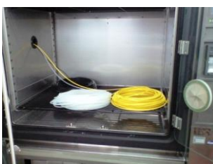
図-6 温度試験の状況
