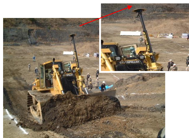
写真-4 GPS 搭載ブルドーザ
