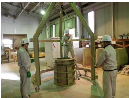
写真-1 超大型締固め試験状況
