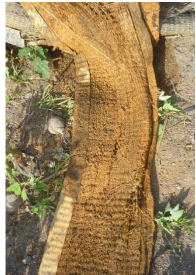
写真2 崩落箇所から採取した裏面排水材
