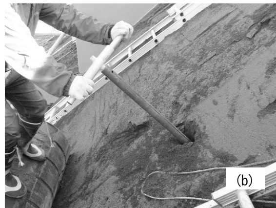
写真-4 計測機器埋設時の状況：(a)ハンドオーガーによる掘削，(b)土壌水分計の設置状況
