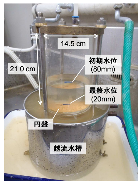
写真5 垂直透水性能試験の様子
