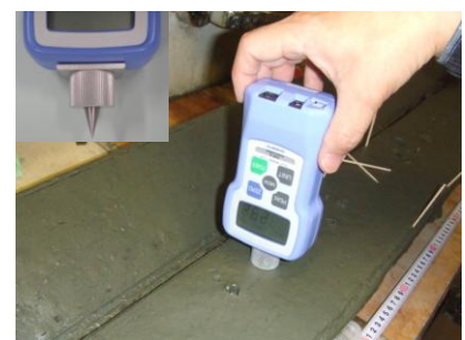
写真-2 コーン貫入試験
