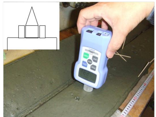
写真2 コーン貫入試験
