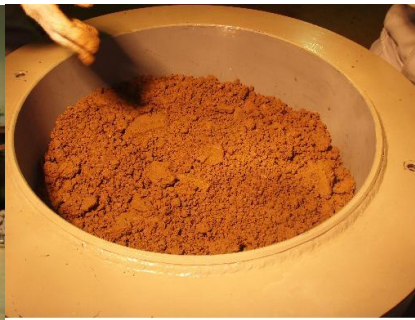
写真-2 突き固め前状況
