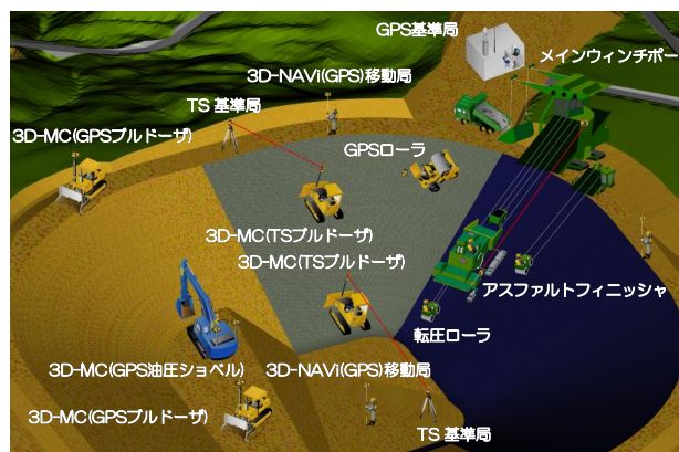
図-15 IT 施工イメージ図
