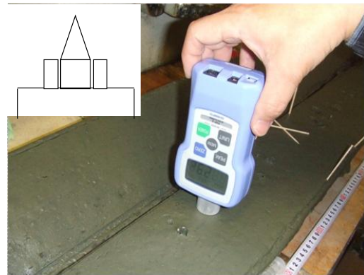
写真-2 コーン貫入試験
