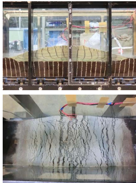
写真-5 ケース4の加振後の状況 (上:側面の状況 下:上面の状況)
