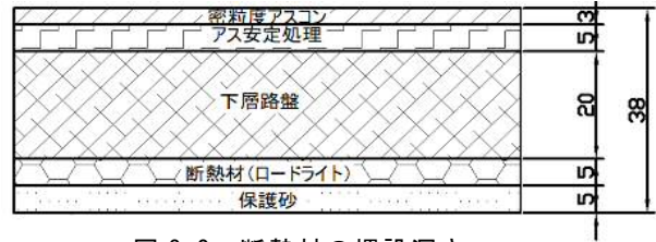
図 3-2 断熱材の埋設深さ
