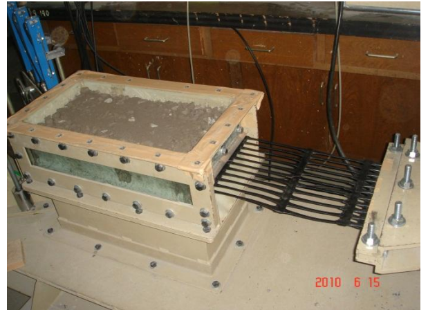
写真-1 引抜き試験装置
