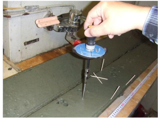
写真-1 ベーンせん断試験
