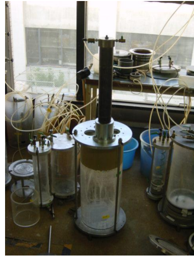
写真2 シンウォールサンプリング中の様子
