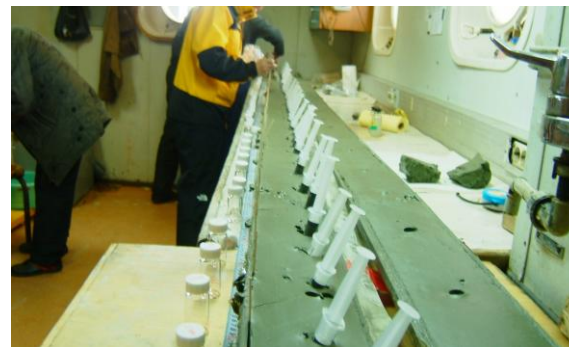
写真-4 含水比試験用の試料採取
