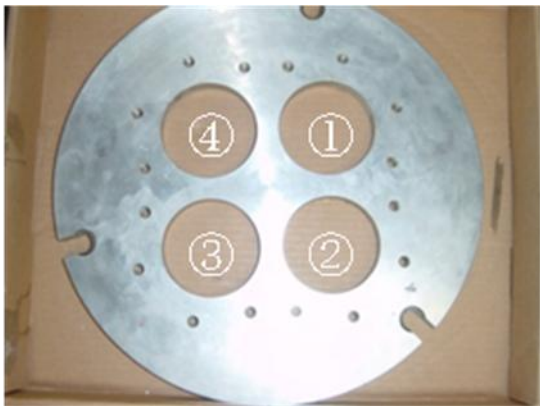
写真3 シンウォールサンプラー固定金具
