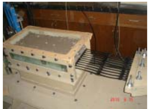
写真-1 引抜き試験装置
