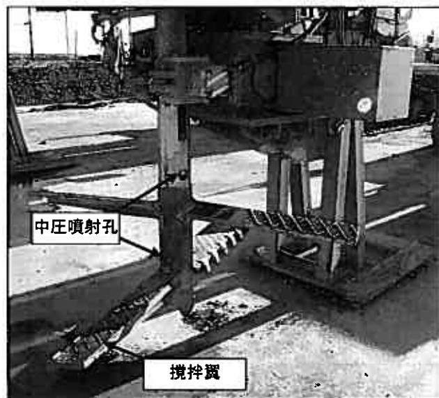
写真-2 MITS 工法の攪拌翼と噴射孔
