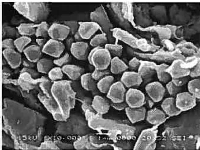
図-3 SEMによる美原粘土の観察（深度18m、倍率10000倍）
