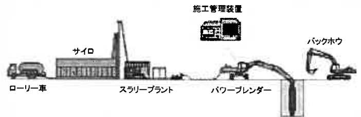
図-2 施工システム
