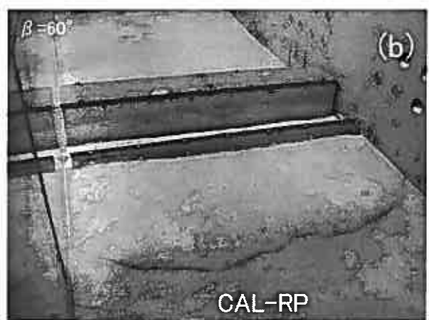
写真-1 CAL-RP 試験後のすべり線の発生状況: (a)地盤内, (b)地盤表面
