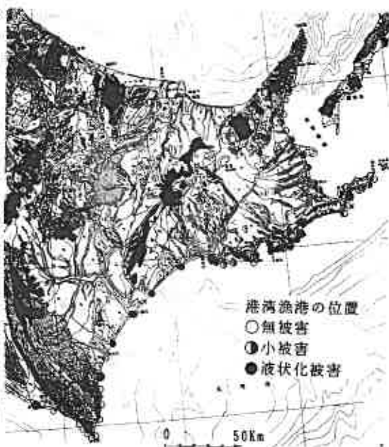
図-2 港湾・漁港の被害や液状化と地質の関連
