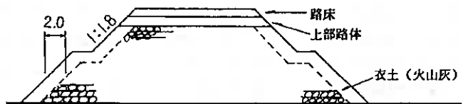
図-5 岩塊盛土の標準断面図
