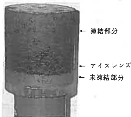
写真-2 凍上試験後の供試体の状況 (改良法)
