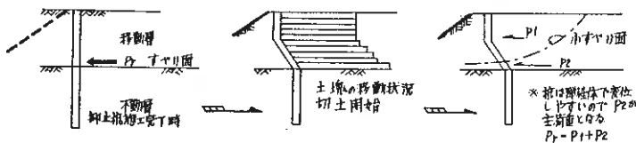
図-15 杭と地盤変位に関する 1モデル
