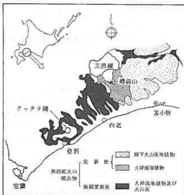
図-1 調査地付近の火山噴出物分布図 北海道地質図(1960)による
