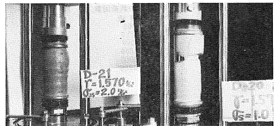
(a) (b) 写真-1 破壊後の供試体の状況
